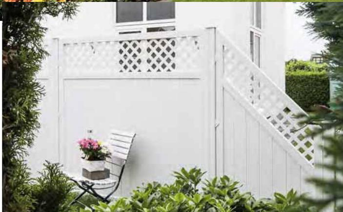
**RIVA (Fensterkunststoff, Weiß):** Große Auswahl an Zaun-/Gitter-Elementen, Profile 24,5 x 125,3 mm, Rahmen 68 x 48 mm (innen verstärkt), Gitterleisten 5 x 30 mm. Pfosten von 105 bis 240 cm. Passende Pfosten, Elemente auf Maß und Tore erhältlich.
